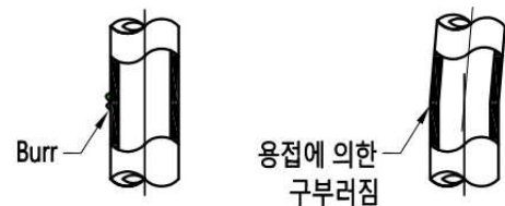
[그림3-4] 부적절한 Pipe 용접 연결
