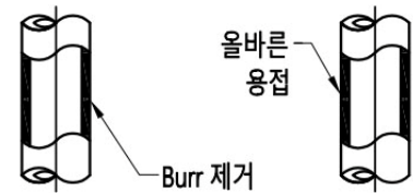
[그림3-2] 적절한 Pipe 용접 연결
