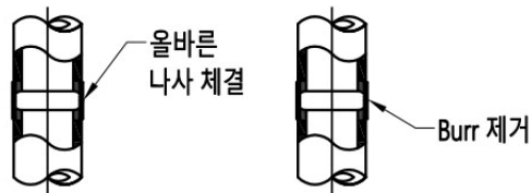
[그림3-1] 적절한 Pipe 나사 연결
